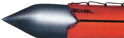
Detalj på hur en tryckutjämningsstrut kan vara konstruerad och limmad.
